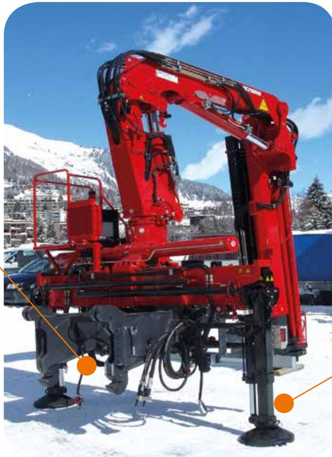
Höhenunterschiede beim Aufsetzen werden durch hydraulisches Aus- und Einfahren von Abstützungen und Ausschub ausgeglichen.
